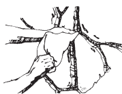
Figura 13 Enlechado de juntas.
