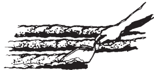
Figura 16 Coloque la mezcla para la instalación de piedras para hogares.
