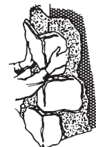
Figura 8 Aplicación de esquineros: alternar tramos cortos y largos en direcciones opuestas.
