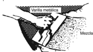
Figura 5 Aplique mezcla con un fratacho.
